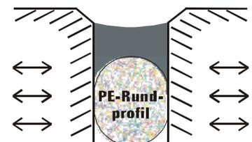
**B) Wikosil-color als Dichtstoff:** Schema einer korrekt dimensionierten Fuge mit Hinterfüllmaterial.
